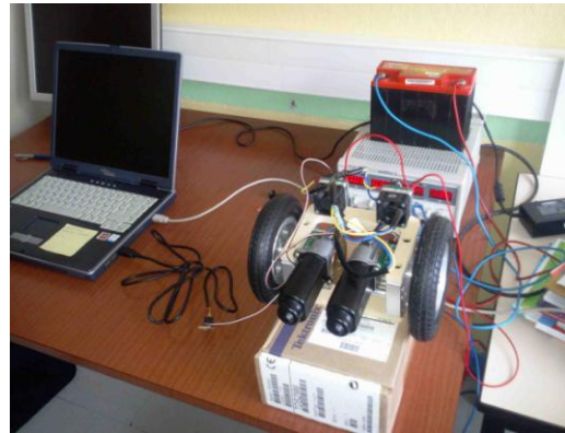
fig 4 : Platine d'essai de communication PC servomoteurs
