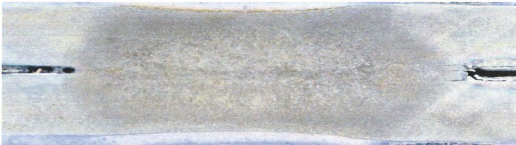
Figure 28 : Coupe transversale d'une soudure par point –
