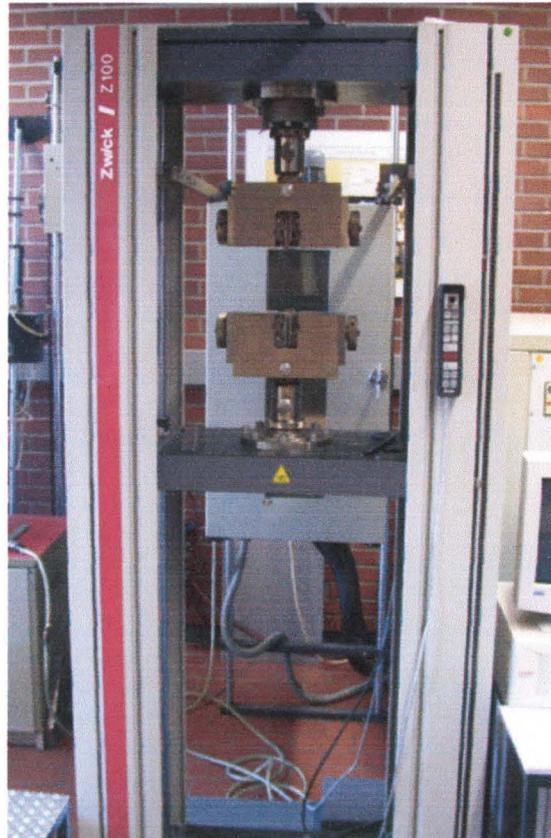
Figure 42 : Machine de traction de type « Zwick 100 »
