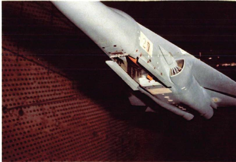
Figure 1.23 – Contrôle passif à l'aide d'un déflecteur en dents de scies (Clark [22])
