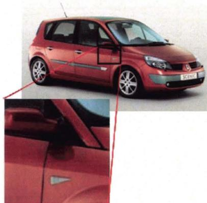
*Figure 1* – Cavités profondes présentes dans un véhicule automobile
