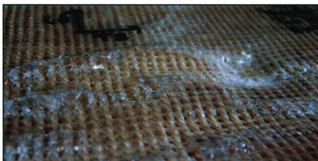
Figure 3. 15: Illustration du problème de pression lors de la réticulation de la résine après l'infusion, cas du « LtoL » Vectran® 40 fils/cm 38 duites/cm, face avant
