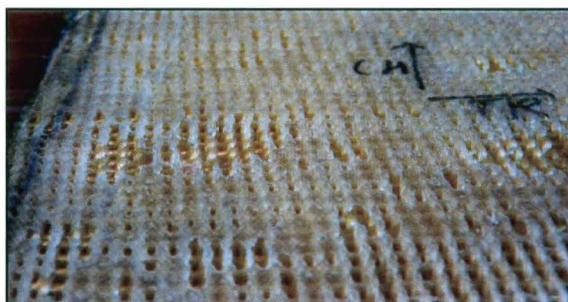
Figure 3. 14: Illustration du problème de pression lors de la réticulation de la résine après l'infusion, cas du « LtoL » Vectran® 40 fils/cm 38 duites/cm, face arrière
