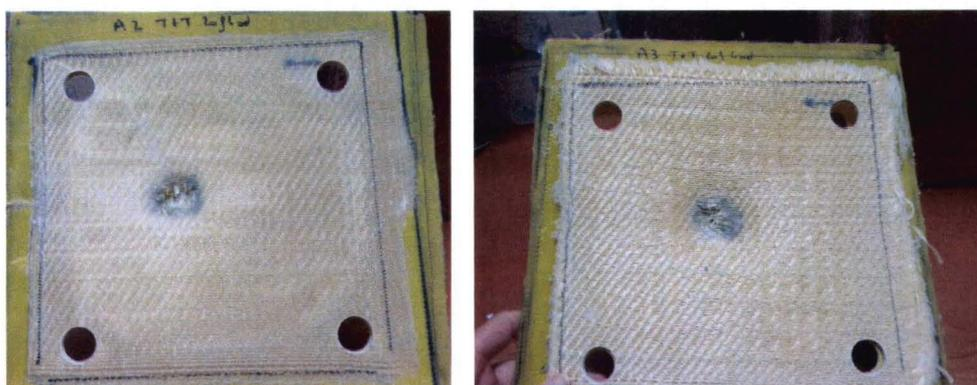
Figure 4. 3: Illustration des différences de compaction d'une plaque à l'autre avec l'interlock A2 et A3
