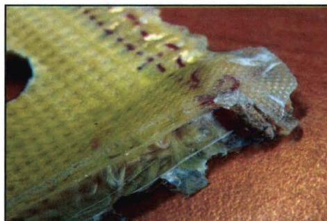
**Figure 3. 13: Illustration du problème de stabilité durant la mise sous vide, cas du « TtT » Kevlar® 40 fils/cm 40 duites/cm**
