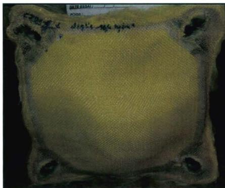
Figure 3. 9: Illustration de l'endommagement suivant le cas 4, avec l'exemple du préimprégné 7 fils/cm 7 duites/cm avec une  $V_e = 1000$  m/s
