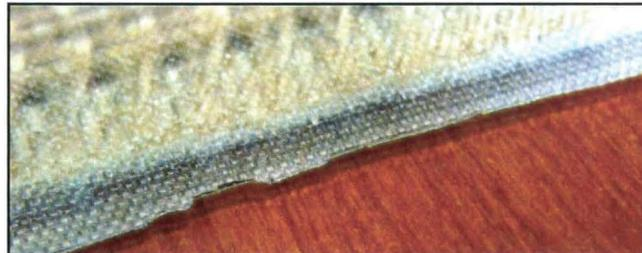
**Figure 3. 12: Dépôt de résine sur les côtés de la structure, illustration avec le « LtoL » Vectran® 40 fils/cm 38 duites/cm**
