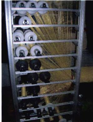
**Figure 2. 26:**Mise en place du système d'ensouple pour délivrer le fil de chaîne
